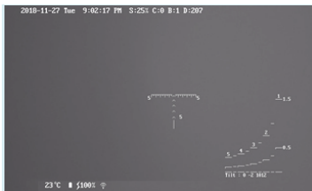
Рис. 9 Тактическая дальномерная сетка прицела
